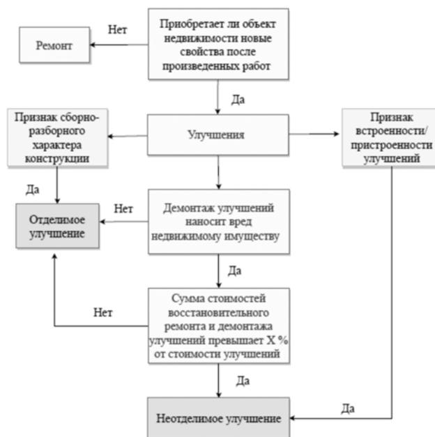
Рис. 1. Алгоритм отнесения улучшений к отдельным или неотделимым в рамках производства судебной строительно-технической экспертизы
